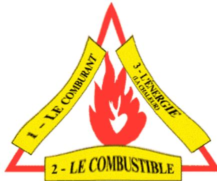
*Figure 34 : Eléments nécessaires pour le déclenchement d'un incendie*
